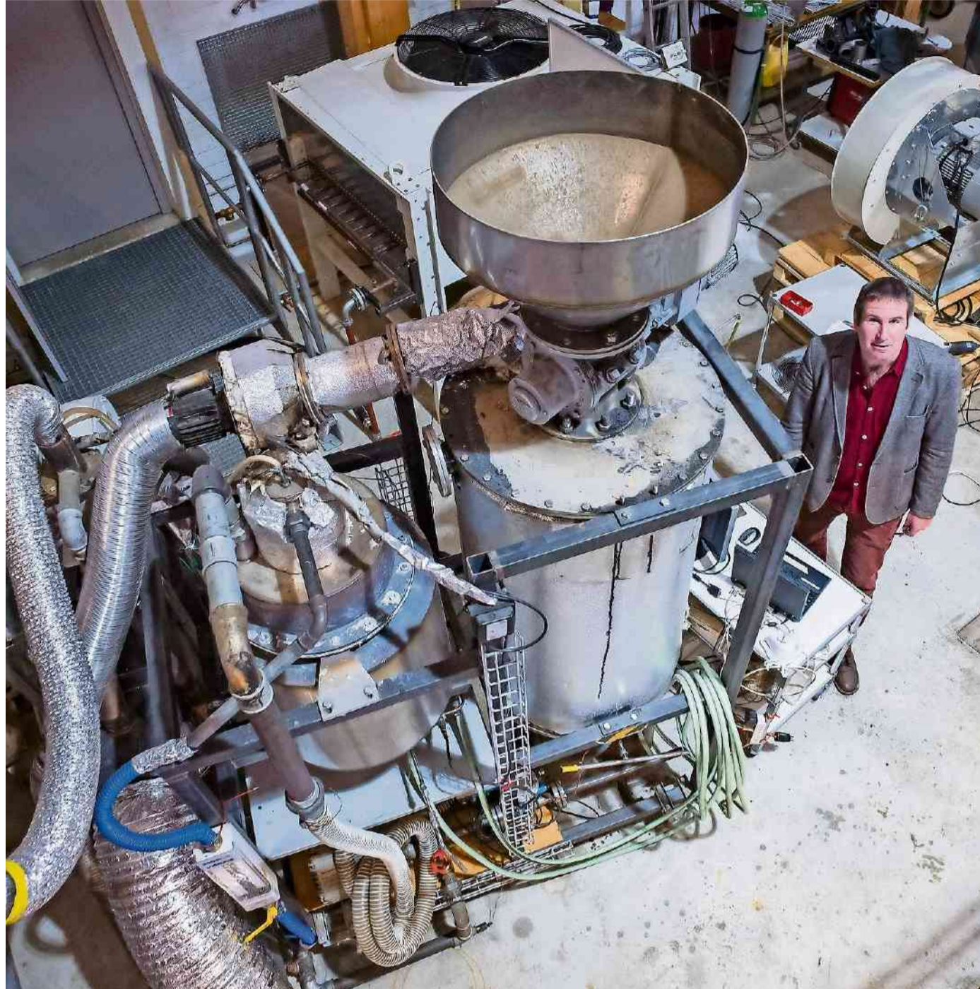
Diesen Pyrolyse-Reaktor hat Martin Schmid für Kaffeebauern in Peru (siehe Text unten) entwickelt.
